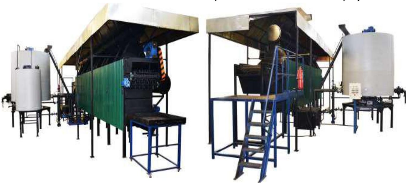
Рисунок 2.3.1 – Технологический комплекс для утилизации отходов битумсодержащих кровельных и изоляционных материалов
